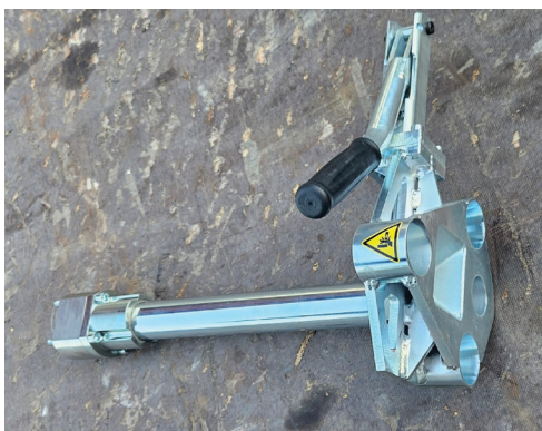
Abb. BEWALOC Schnellkoppler mechanisch zum Einbau in Ibex G28 Geräteträger
