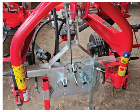
Abb. BEWALOC Koppelplatte inkl. Stützfuss montiert an Kreiselheuer
