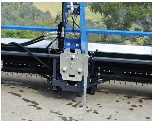
Abb. BEWALOC Koppelplatte inkl. Stützfuss montiert an Seeber Allroundmax inkl. Adapter
