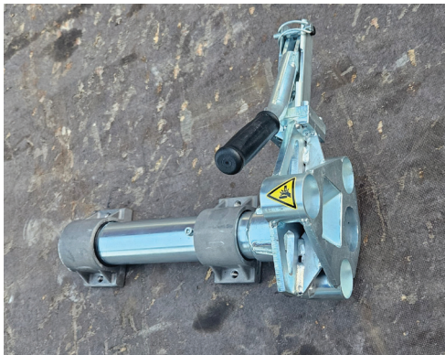
Abb. BEWALOC Schnellkoppler mechanisch zum Einbau in Brielmaier Geräteträger
