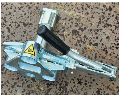
Abb. BEWALOC Schnellkoppler mechanisch zum Einbau in Ibex G4 Geräteträger
